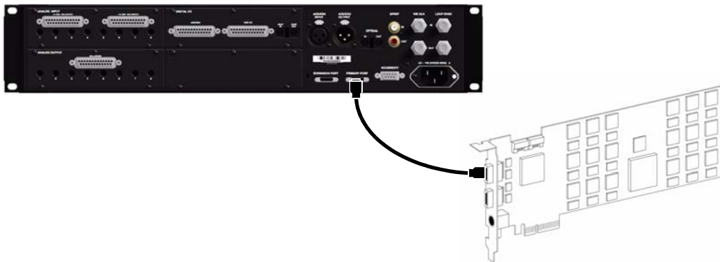
図 1. HDXカードのDigiLink Mini Port 1に接続したHD I/O
