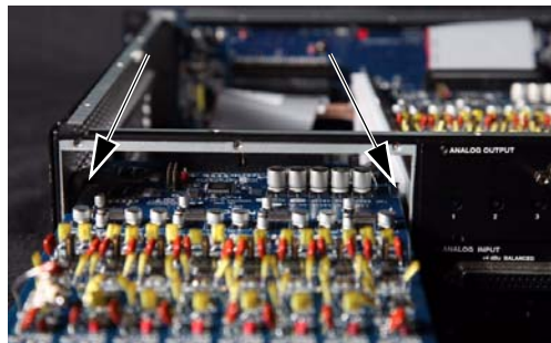
空のベイのガイド・レールへカードを挿入する
